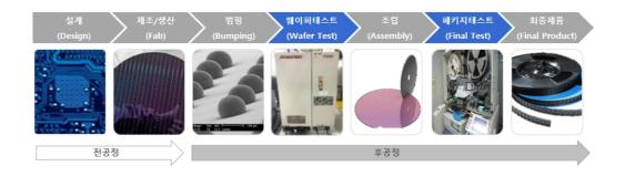
반도체 테스트 시장은 메모리 반도체와 시스템 반도체의 구분에 따라 요구되는 스펙이나 특성이 상이한 편입니다. 메모리 반도체의 경우 표준화된 제품으로 대량생산을 위한 목적이 뚜렷하기 때문에 동시에 많은 수량의 테스트가 가능한 장비 개발 및 생산방법 위주로 발전되어 온 반면 시스템 반도체는다품종의 제품에 대한 다양한 방법의 테스트를 요구하기 때문에 동일 장비로 얼마나 많은 종류의 칩을 테스트할 수 있는지에 대한 역량이 더 중요하게 여겨집니다. 시스템 반도체 테스트 장비는 메모리반도체 테스트 장비에 비하여 상대적으로 낮은 가격이지만 테스트 되는 제품의 종류 및 특성에 따라테스트 장비의 종류가 세분화되어 있습니다. 따라서 시스템 반도체의 경우 다양한 종류의 제품에 대응이 가능한 테스트 장비의 구축과 이를 운용할 수 있는 전문 엔지니어의 확보, 운용 노하우가 매우중요한 경쟁력으로 대규모의 투자와 더불어 테스트 엔지니어의 육성 및 확보가 선행되어야 합니다.
